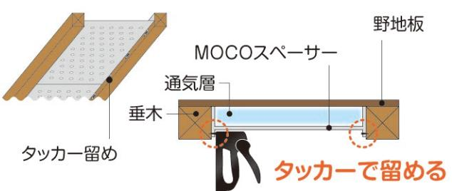
屋根の野地板の内側に、通気スペーザー「MOCOスペーザー」を施工し、通気層を確保した後に、断熱材MOCOフォームを吹付けます。
